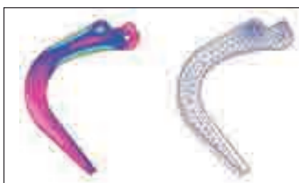
Figure 2. Calcul d'une griffe par éléments finis
